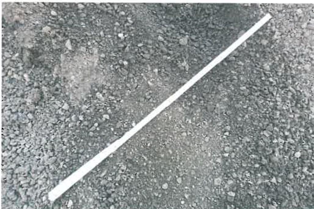
Foto 2: Detailaufnahme der recycelten Gesteinskörnung
